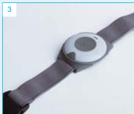
3 Funkarmband – drahtlose Signalgeber, die direkt am Körper getragen werden können.
